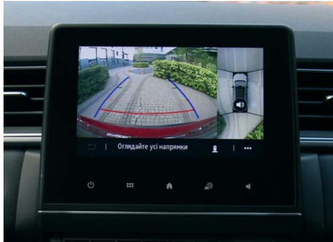
Відеокамера на 360° з панорамним оглядом дозволить
